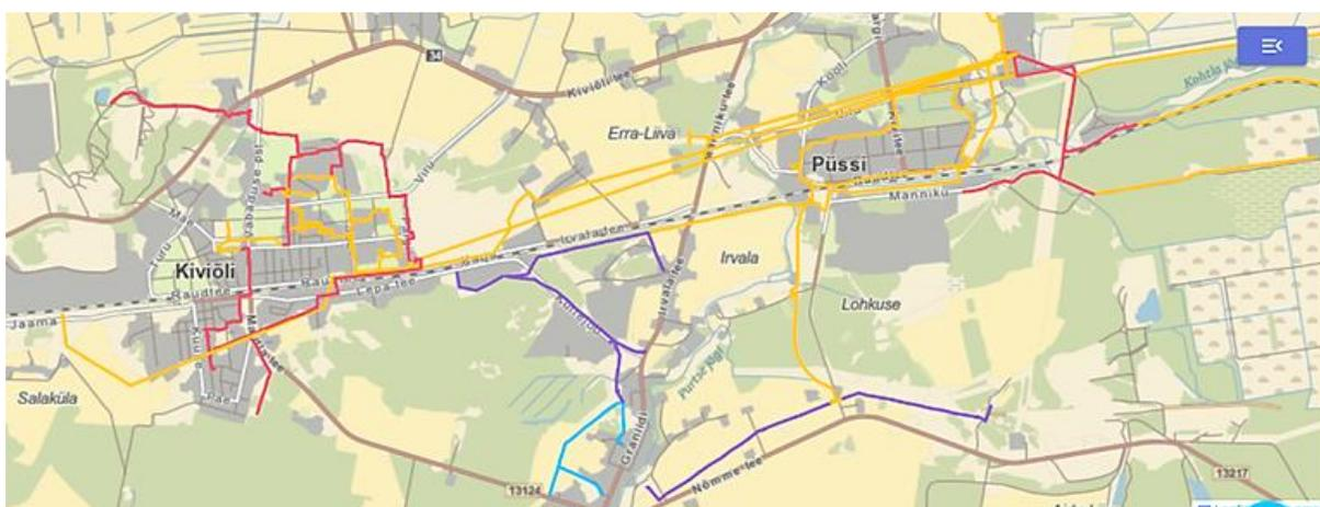
Рисунок 16 - Свободные мощности в городах Кивиõли и Пюсси, красным - 5000 кВт, желтым - 1000 кВт, фиолетовым - 500 кВт, синим - 200 кВт.
