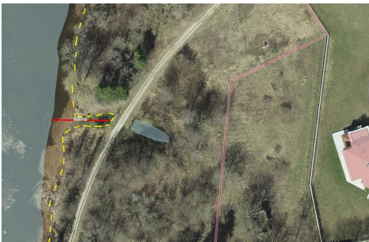
Joonis 8. Näited tegeliku kaldajoone ja Põhikaardi kaldajoone erinevustest Ülemiste järve idakaldalt.
